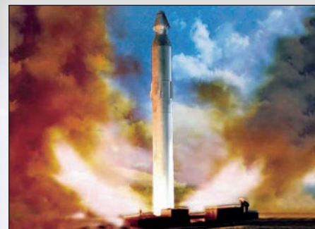
Старт из подземной шахты ракеты Р-36 с разделяющейся головной частью. Эта ракета стала базовой для создания целого ряда ракетных комплексов.
